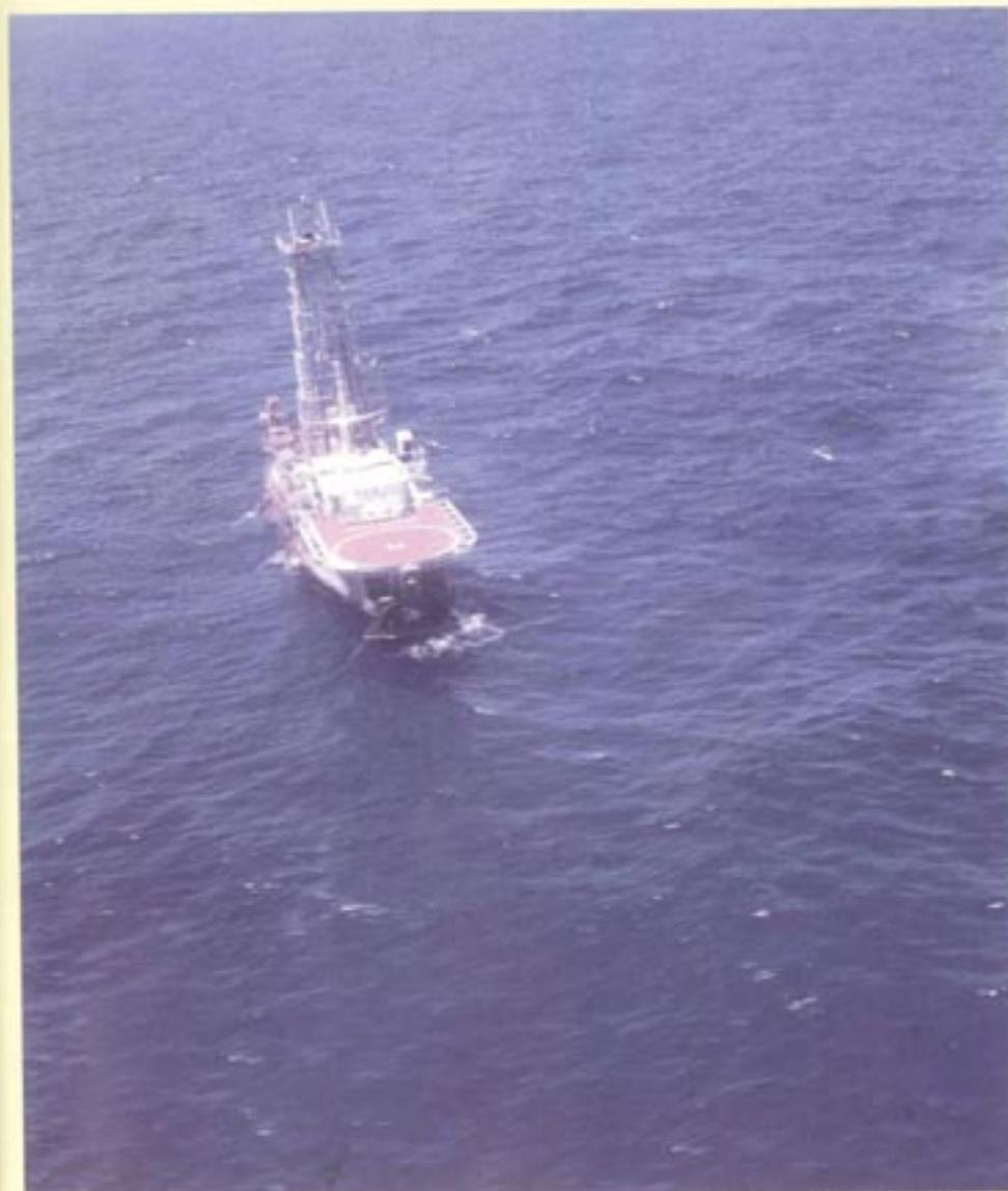
Figura 9 – Navios geotécnicos ancorados (quatro âncoras) para lâminas d'água de até aproximadamente 200 metros
