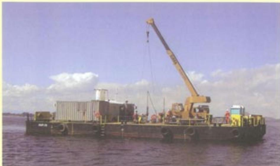
Figura 2 - Balsa Geotécnica
